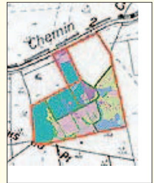
Calcul, par croisement de couches, des superficies de chaque milieu par clos de pâturage, et par parcelle cadastrale.
